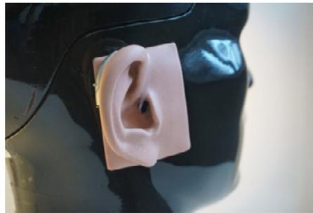
Hinter-dem-Ohr mit Schlauch
