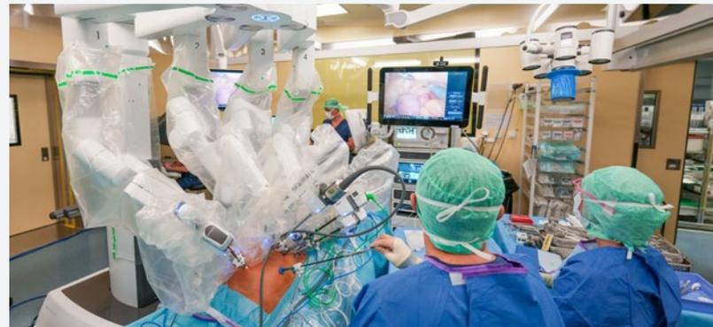
Das mit vier Gelenkarmen ausgestattete Instrument wird mithilfe von Steuerkonsolen bedient. Die Chirurgin oder der Chirurg sitzt dabei in einer bequemen Position und kann dank des zehnfach vergrösserten 3D-Bildes vom zu operierenden Bereich mit der Konsole hochpräzise Bewegungen ausführen.
